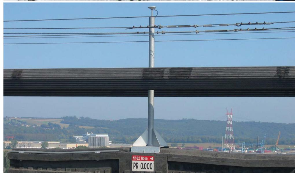
Sur le territoire français, la mesure précise des altitudes des montagnes (ci-dessus au sommet de la Barre des Ecrins) ou la surveillance des ouvrages d'art (ci-dessus un des récepteurs bifrèquence GNSS installés sur le pont de Normandie), par exemple, s'appuient régulièrement sur le réseau Teria.
