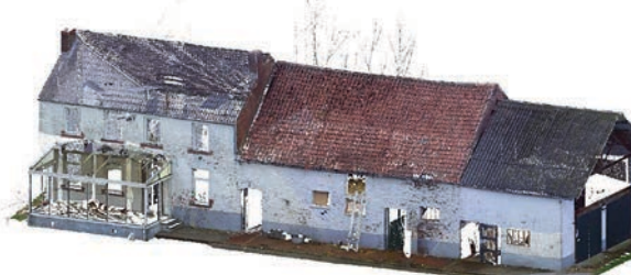
Opération de coloriage du nuage de points 3D à l'aide des images acquises par photos prises par le scanner (5Mp) ou photos prises à l'aide d'un appareil photo.
