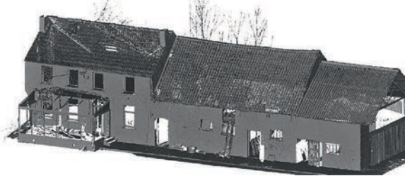
Opération de coloriage du nuage de points 3D à l'aide des images acquises par photos prises par le scanner (5Mp) ou photos prises à l'aide d'un appareil photo.
