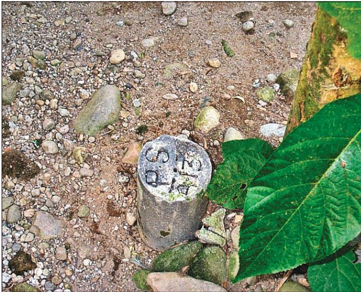
Figure 12.14 Cette marque en béton avec identification numérique est utilisée aux Philippines.
