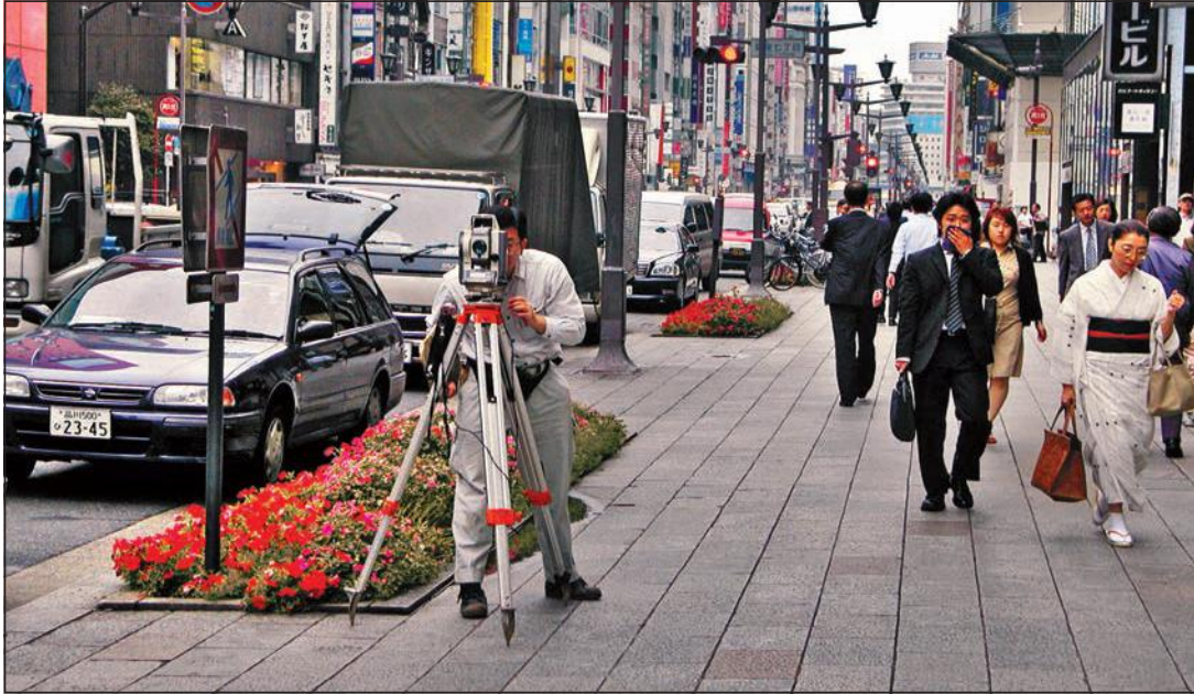
Figure 12.17 Géomètre effectuant un arpentage cadastral à l'aide d'un théodolite numérique à Tokyo (Japon)
