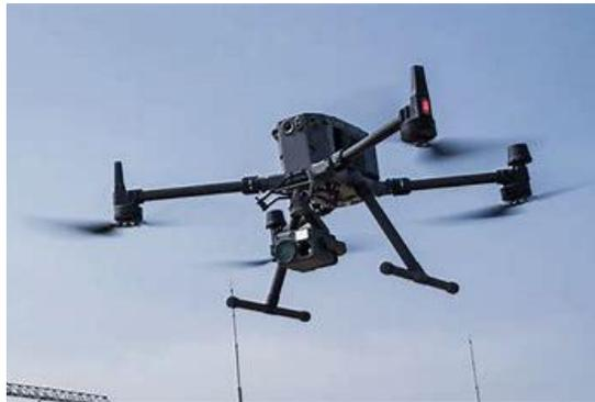
Drone DJI MATRICE 350 avec un capteur LIDAR L2
